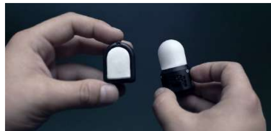
„Digit 360“, taktiler Sensor, vorgestellt im Oktober 2024 von Forschern bei Meta. In beta.
