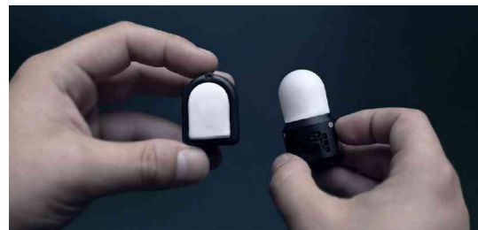
„Digit 360“, taktiler Sensor, vorgestellt im Oktober 2024 von Forschern bei Meta. Aktuell eine beta-Version.
